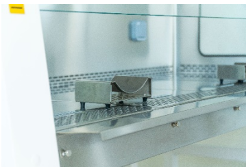
Armauflage im Arbeitsbereich
