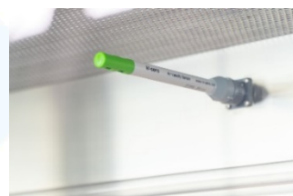
Sonde de vitesse d'air interne pour la surveillance.
